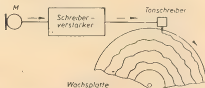
Bild 271: Schematische Darstellung des Aufnahmevorganges beim Nadeltonverfahren
